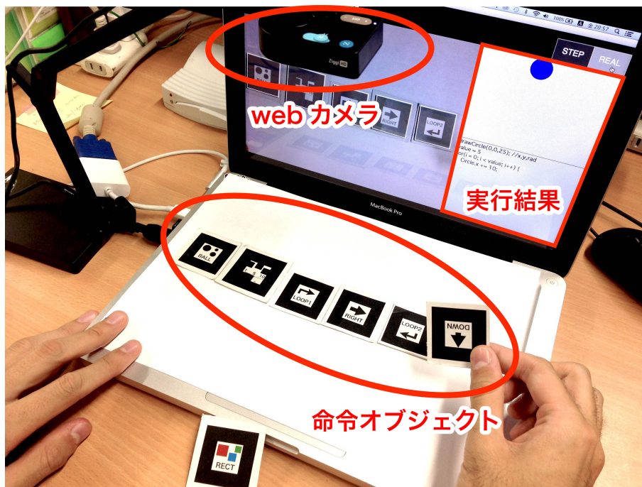
図 3.3: 図形や音の操作が可能な紙媒体を用いたプログラミング環境で用いるシステムの全体像
