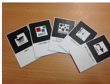
図 3.1: 図形や音の操作が可能な紙媒体を用いたプログラミング環境で用いる命令オブジェクトの概要 図 3.2: 図形や音の操作が可能な紙媒体を用いたプログラミング環境で用いる命令オブジェクトの例
