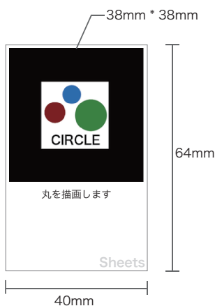
図 3.1: 図形や音の操作が可能な紙媒体を用いたプログラミング環境で用いる命令オブジェクトの概要 図 3.2: 図形や音の操作が可能な紙媒体を用いたプログラミング環境で用いる命令オブジェクトの例
