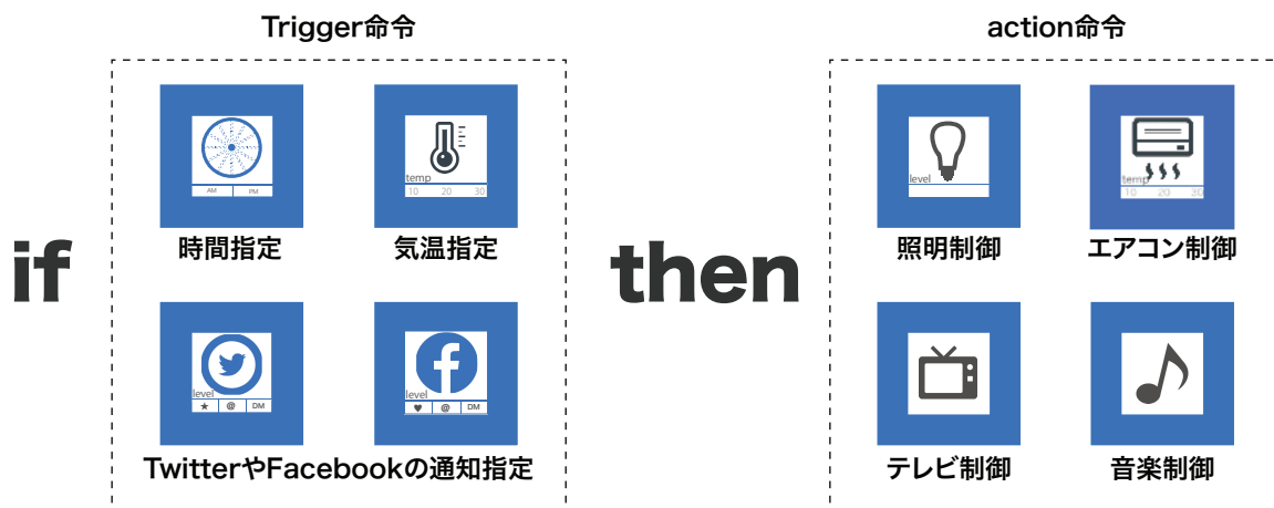
図 5.4: if-then 形式で指定する Trigger と Action の命令例
