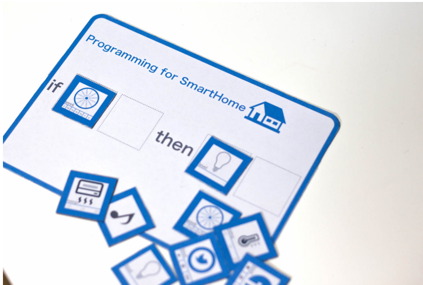
図 5.1: 実世界制御が可能な紙媒体を用いたプログラミング環境で使用される紙製命令カード
