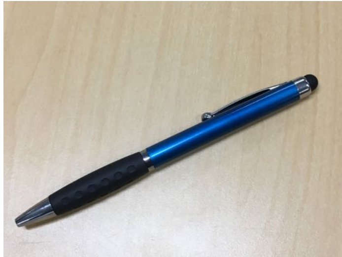
図 4.9: 実験に使用した静電容量用タッチペン。ペンの頭の部分がタッチペンとなっている。
