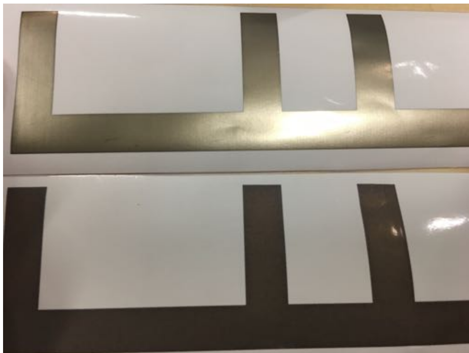
図 10.1: (上) 通常の識別子. (下) 酸化して色が変わった識別子. 酸化により若干茶色くなっている. また, 上の識別子と異なり, 光を反射しなくなっている.
