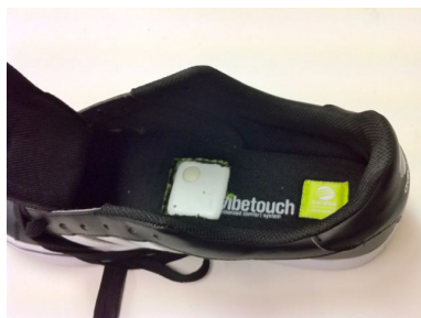
図 4.3: 靴底に取り付けたセンサ
