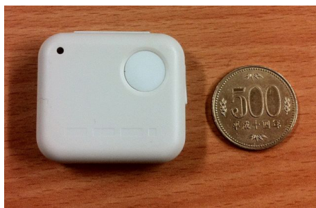
図 4.2: 複合センサモジュール WAA-010
