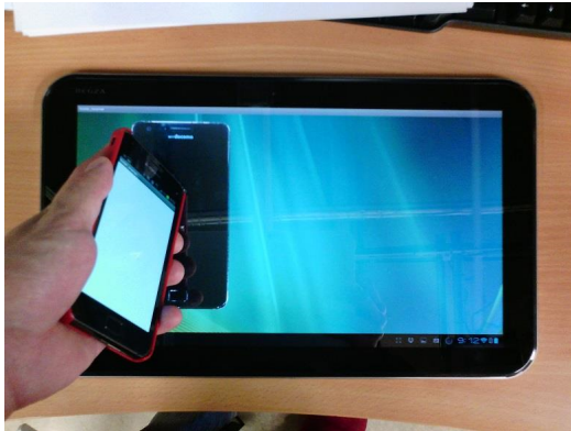
(1) 小端末を大端末のタッチパネルに接触させる
