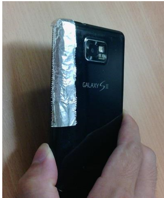
図 3.4: アルミニウム箔を貼った端末
