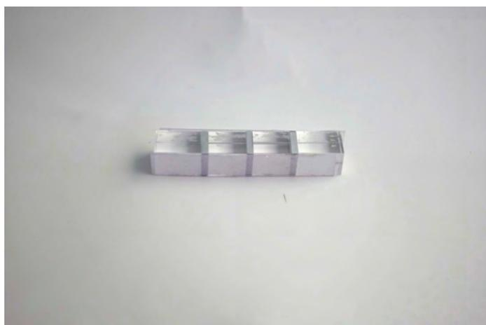
図 A.26: 導電部 12 mm, 非導電部 2 mm
