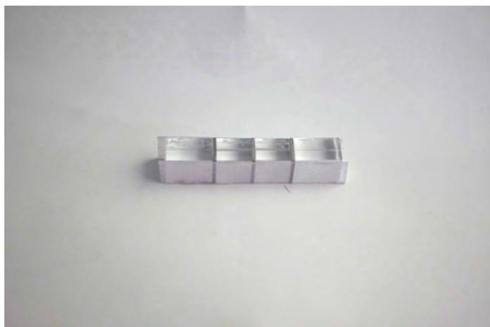
図 A.21: 導電部 11 mm, 非導電部 1 mm
