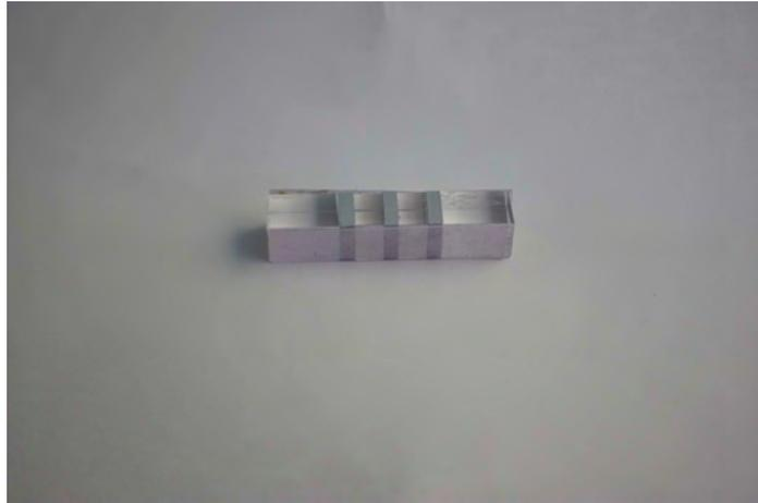
図 A.7: 導電部 7 mm, 非導電部 3 mm
