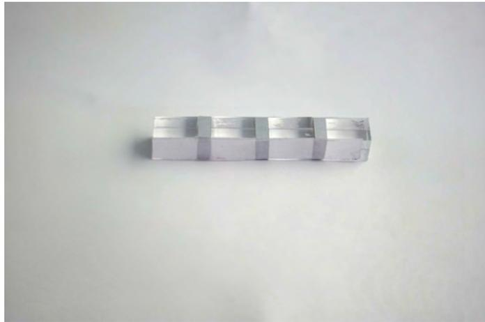
図 A.40: 導電部 15 mm, 非導電部 4 mm
