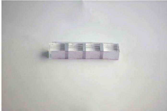
図 A.31: 導電部 13 mm, 非導電部 3 mm
