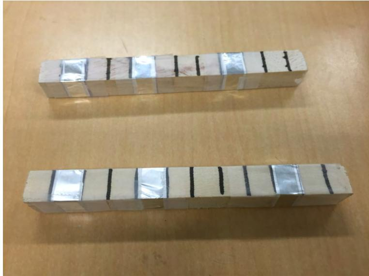
図 4.11: アルミ箔テープと木製棒を用いたマーカ
