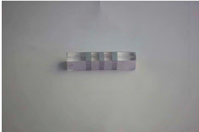
図 A.8: 導電部 7 mm, 非導電部 4 mm
