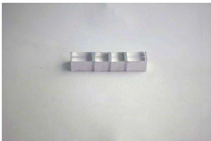
図 A.18: 導電部 10 mm, 非導電部 2 mm
