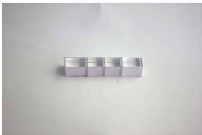
図 A.22: 導電部 11 mm, 非導電部 2 mm
