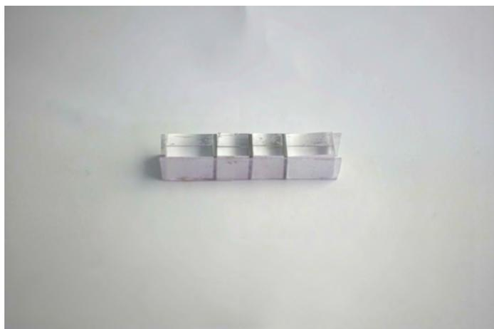
図 A.17: 導電部 10 mm, 非導電部 1 mm
