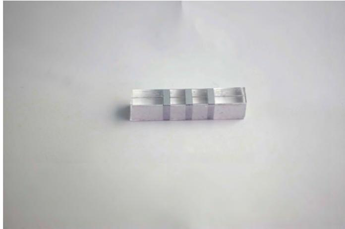
図 A.3: 導電部 6 mm, 非導電部 3 mm
