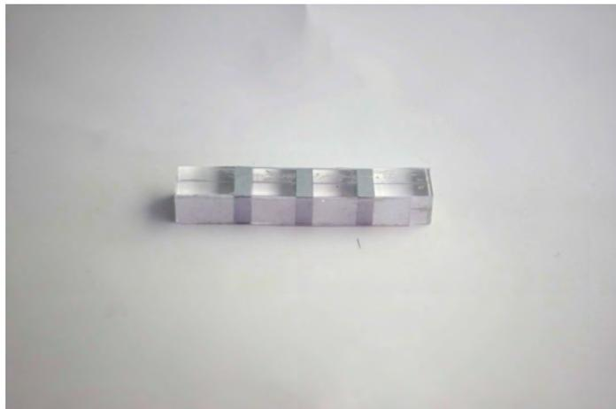
図 A.24: 導電部 11 mm, 非導電部 4 mm
