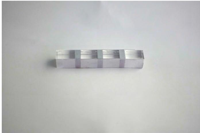
図 A.32: 導電部 13 mm, 非導電部 4 mm
