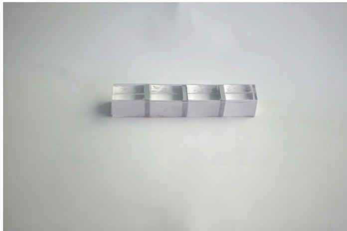
図 A.38: 導電部 15 mm, 非導電部 2 mm
