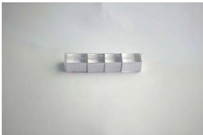
図 A.25: 導電部 12 mm, 非導電部 1 mm
