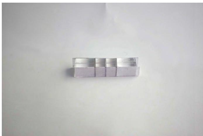
図 A.1: 導電部 6 mm, 非導電部 1 mm
