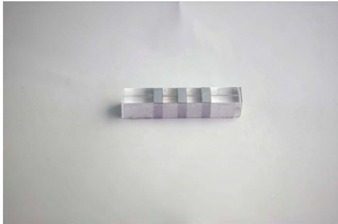
図 A.4: 導電部 6 mm, 非導電部 4 mm
