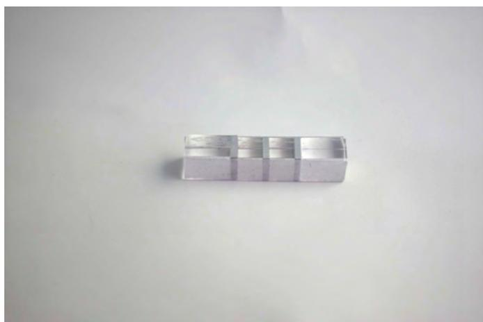
図 A.10: 導電部 8 mm, 非導電部 2 mm
