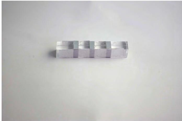
図 A.20: 導電部 10 mm, 非導電部 4 mm
