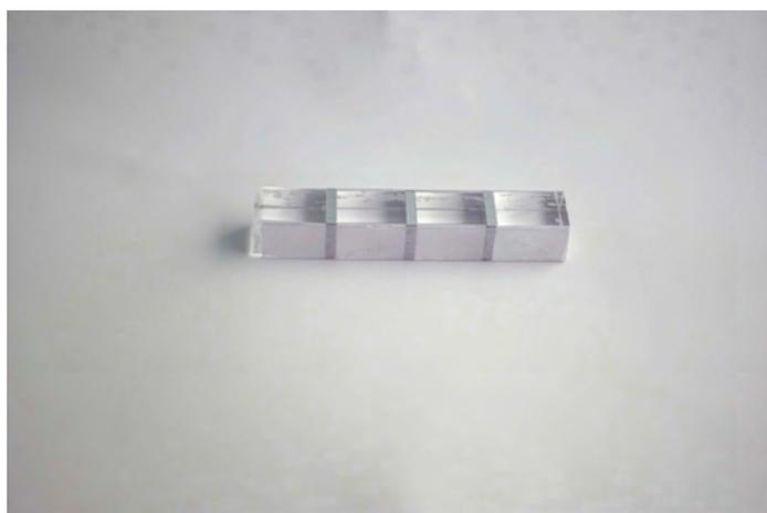
図 A.34: 導電部 14 mm, 非導電部 2 mm
