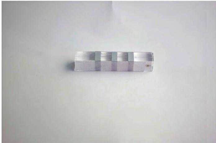
图 A.12: 导电部 8 mm, 非导电部 4 mm
