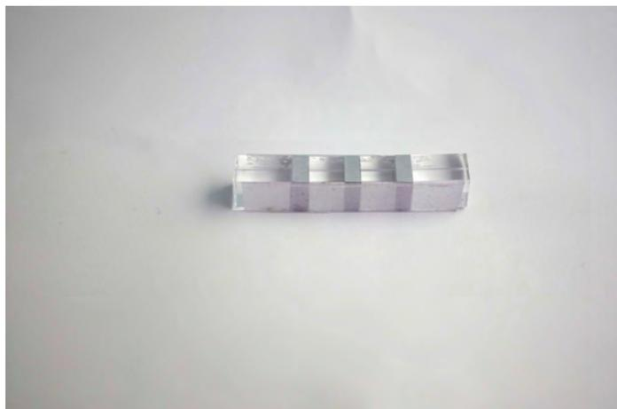
図 A.16: 導電部 9 mm, 非導電部 4 mm
