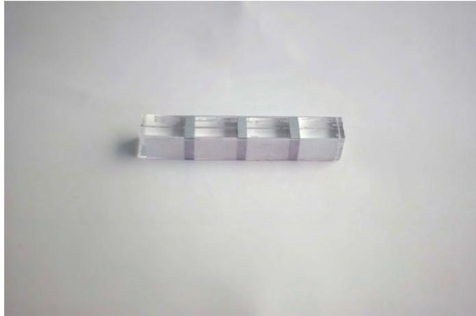
図 A.35: 導電部 14 mm, 非導電部 3 mm
