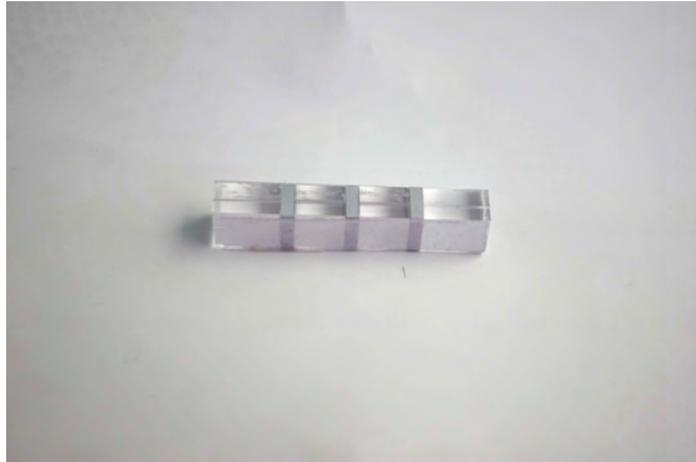
図 A.23: 導電部 11 mm, 非導電部 3 mm
