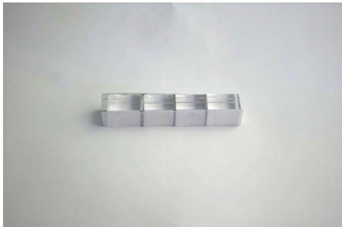
図 A.29: 導電部 13 mm, 非導電部 1 mm
