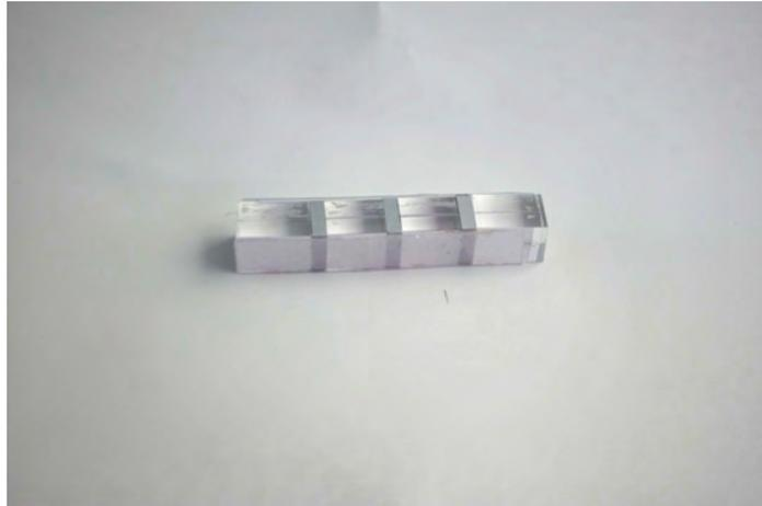
図 A.27: 導電部 12 mm, 非導電部 3 mm
