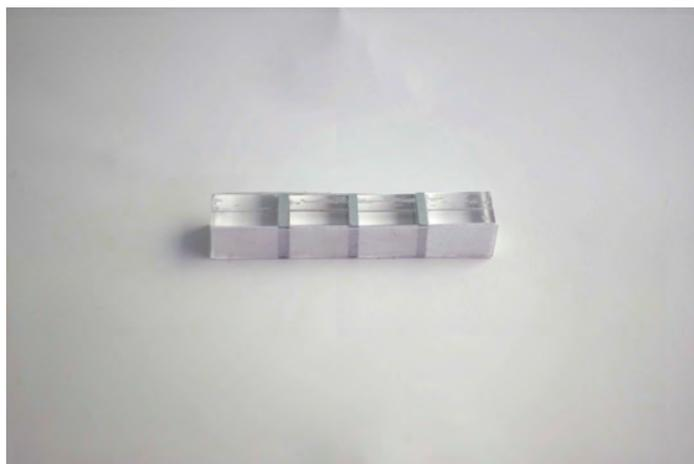
図 A.30: 導電部 13 mm, 非導電部 2 mm
