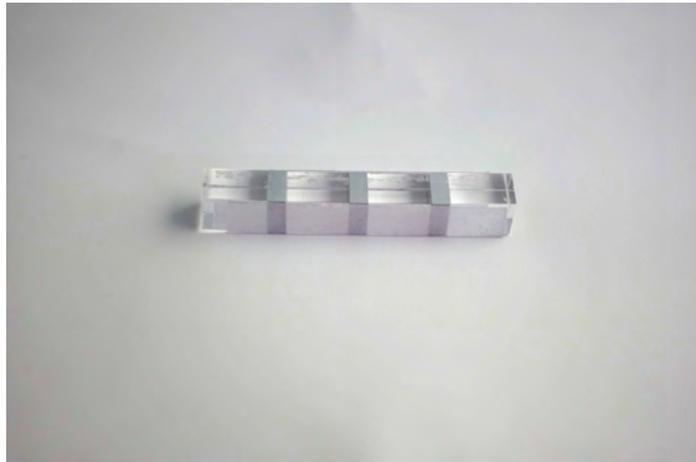
図 A.36: 導電部 14 mm, 非導電部 4 mm
