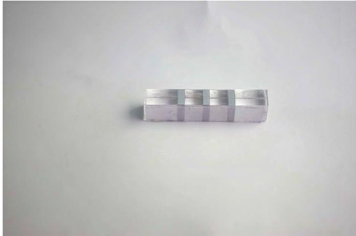
图 A.11: 导电部 8 mm, 非导电部 3 mm
