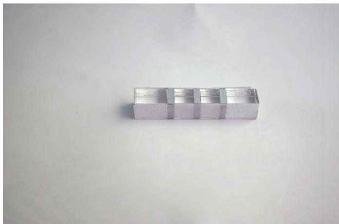
図 A.15: 導電部 9 mm, 非導電部 3 mm
