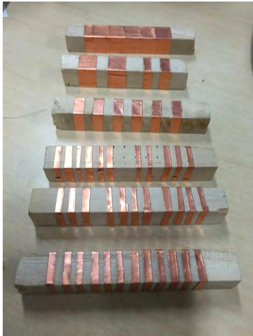
図 4.13: 木製棒と金属箔テープを用いたマーカの試作品群
