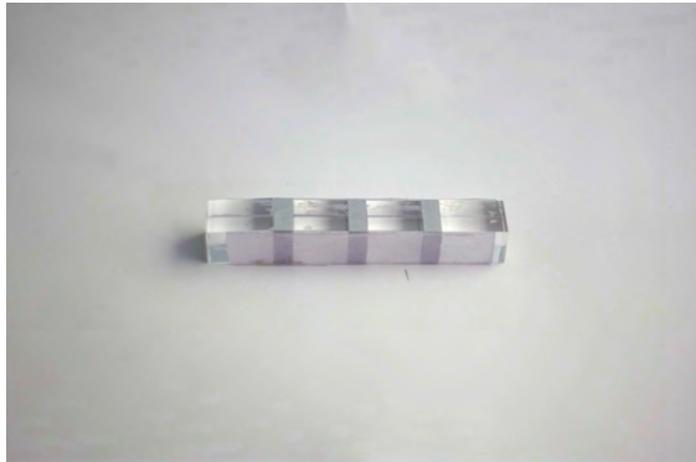
図 A.28: 導電部 12 mm, 非導電部 4 mm
