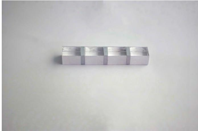
図 A.39: 導電部 15 mm, 非導電部 3 mm
