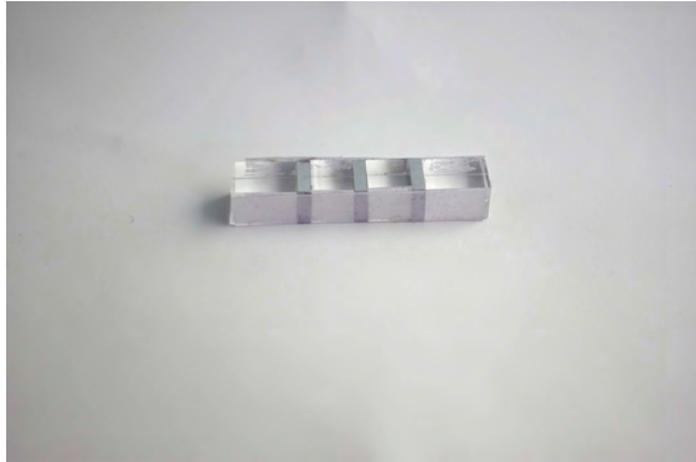
図 A.19: 導電部 10 mm, 非導電部 3 mm
