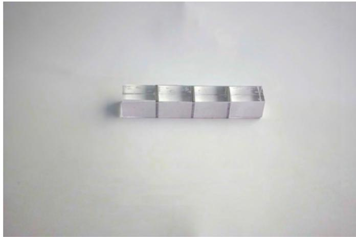
図 A.37: 導電部 15 mm, 非導電部 1 mm
