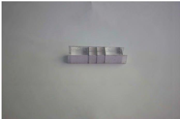
図 A.5: 導電部 7 mm, 非導電部 1 mm
