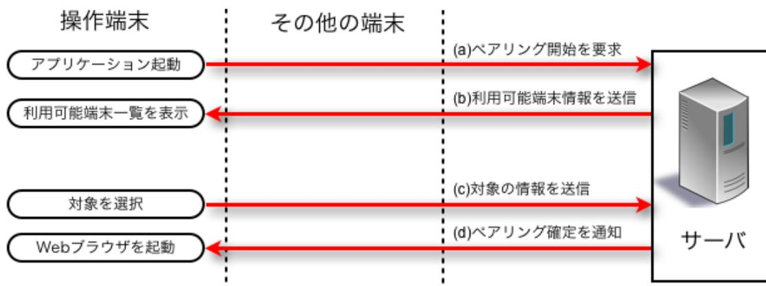
図 3.7: クライアントサイド ペアリング部の処理の流れ (カメラ非搭載端末)
