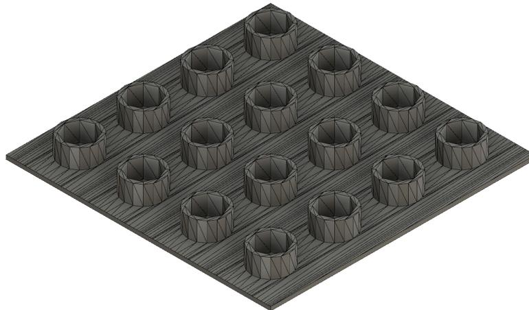
**B.7** 4×4の突起を持つ筐体上部の3Dモデルの三面図
