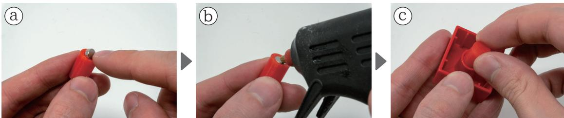
図 4.4: 磁気ブロックの組み立て方法。
