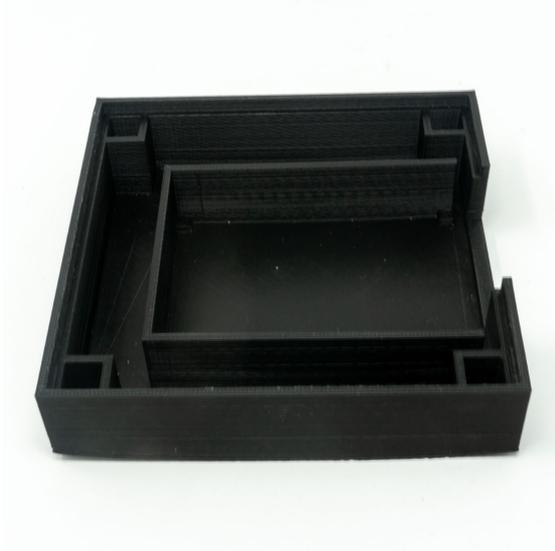
図 4.11: 筐体下部 (3 軸磁気センサアレイを格納する)。
