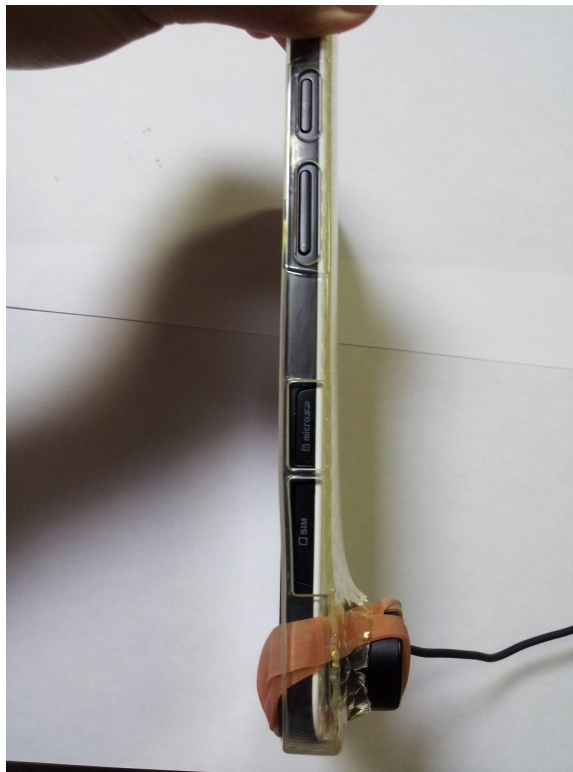
図 4.3: タブレット PC にコンクリートマイクを取り付けた様子 (側面図)
