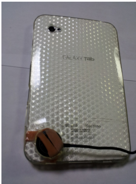
図 4.2: タブレット PC にコンクリートマイクを取り付けた様子
