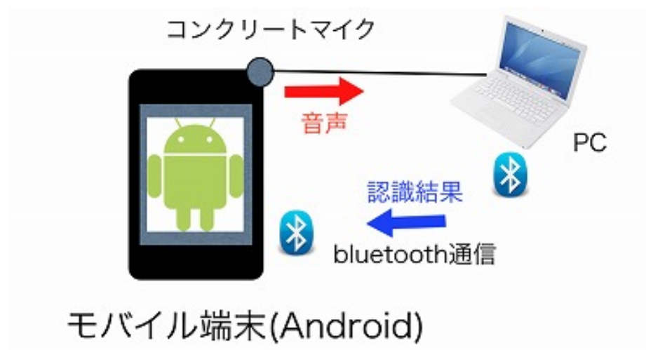
図 4.1: アプリケーションシステム構成
