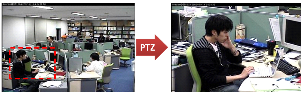
図 1.1: 研究室に設置された PTZ 機能をもつライブカメラが撮影した画像の例
