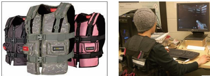
図 2.5: FPS におけるダメージを演出する装置。左図：空気圧を呈示するベスト [6]。右図：ソレノイドによる衝撃を呈示するベスト [7]
