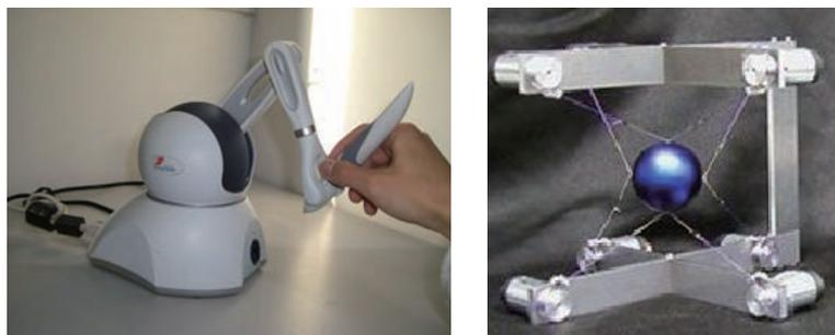
図 2.2: 力覚呈示装置．左図<sup>1</sup>：SensAble 社 PHANTOM OMNI[2][3]．右図<sup>2</sup>：SPIDER[4]
