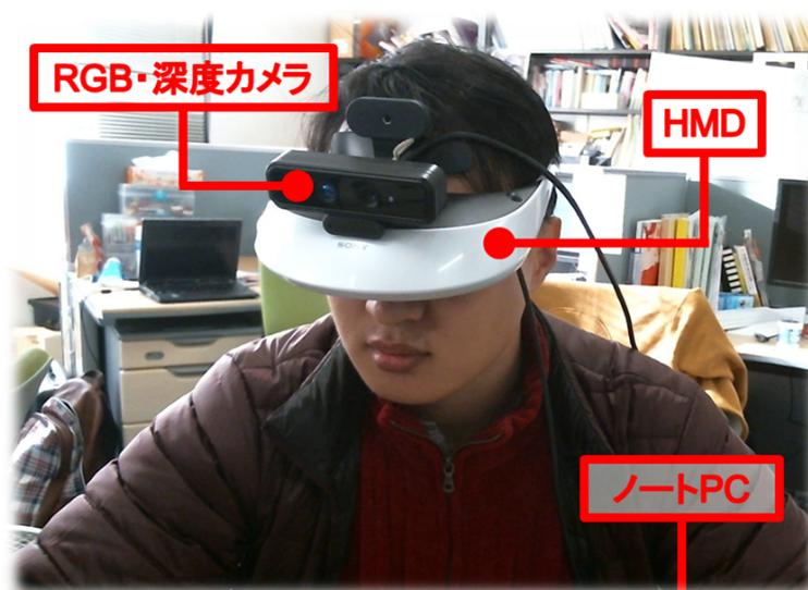
図 3.1: プロトタイプシステムの装着様子
