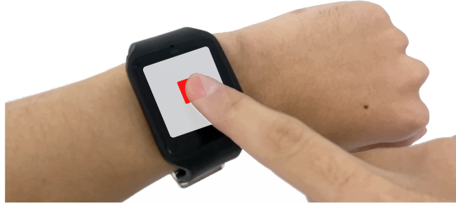
図 1.1: ターゲット選択操作をスマートウォッチのタッチディスプレイを用いて行う様子。
