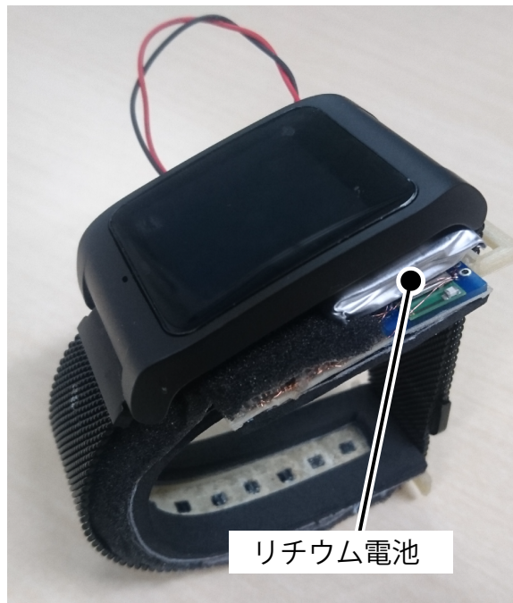
図 5.5: スマートウォッチベルト一体型センサデバイス.
