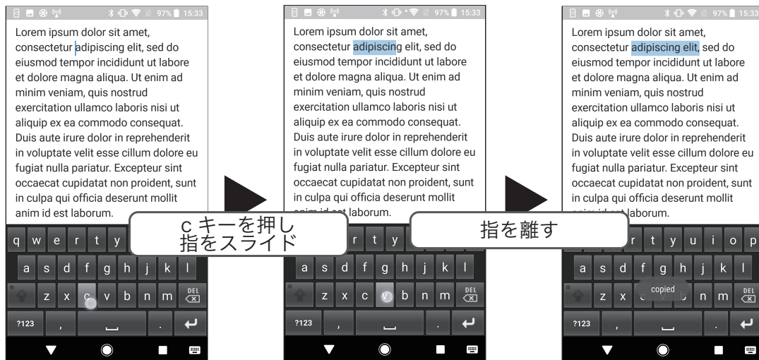
図 6.1: スライド手法におけるキャレット移動および文字列操作. 上段: スライド手法におけるキャレット操作. ユーザは4段目のキーを押下後, タッチスクリーンから指を離すことなくスライドする事によってキャレットを移動させることができる. 下段: スライド手法における文字列操作. 目的の操作が割り当てられたキーを押下した後, タッチスクリーンから指を離すことなくスライドする事によって, スライドした方向に選択範囲が拡張される. さらに, 指を離すことによって最初に押下したキーに割り当てられたコマンドが実行される.
