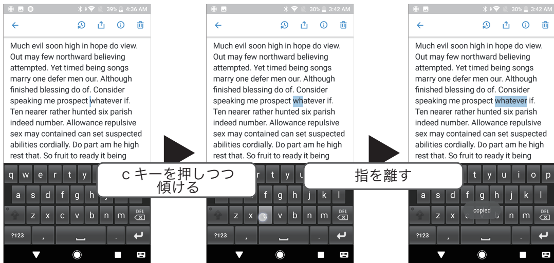
図 4.1: 傾け手法におけるキャレット移動および文字列操作. 上段: 傾け手法を用いたキャレット操作. 下段: 傾け手法を用いた文字列操作手法. 文字列 (“whatever”) をコピーしている.
