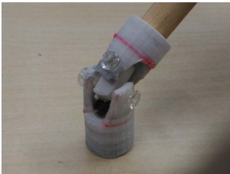
図 4.3: プロトタイプ B (関節) 2 自由度
