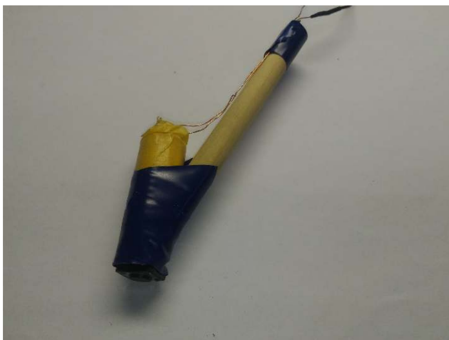
図 4.7: 電磁石式スタイラス
