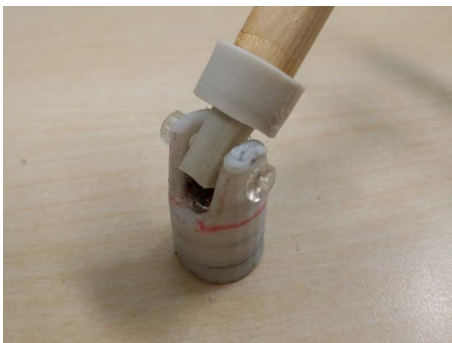
図 4.4: プロトタイプ B (関節) 1 自由度
