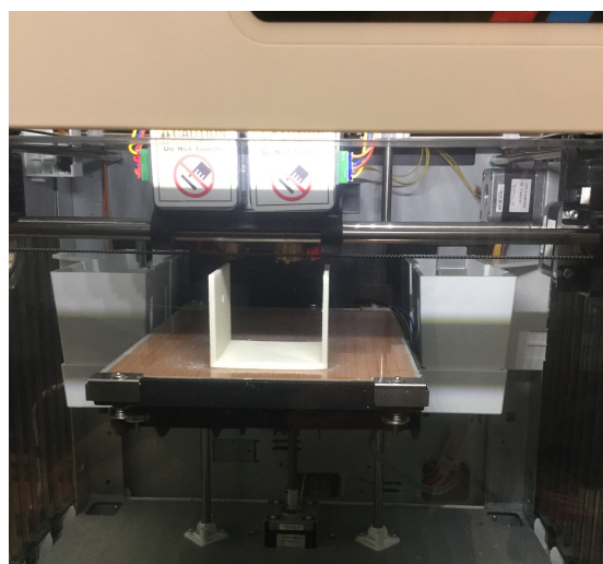
図 4.4: 使用した 3D プリンタおよびケース作成の様子
