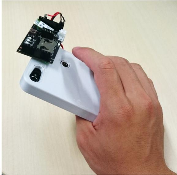
図 3.2: スマートフォンケースとセンサモジュールからなるプロトタイプシステム.
