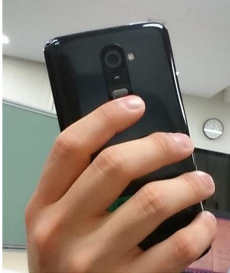
図 1.1: 背面操作の例 (LG G2 L-01F スマートフォン) .
