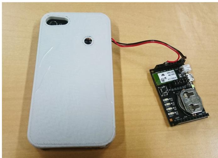
図 4.1: 距離センサ実装。ケース内に埋め込まれたフォトリフレクタは，konashi に接続されている。
