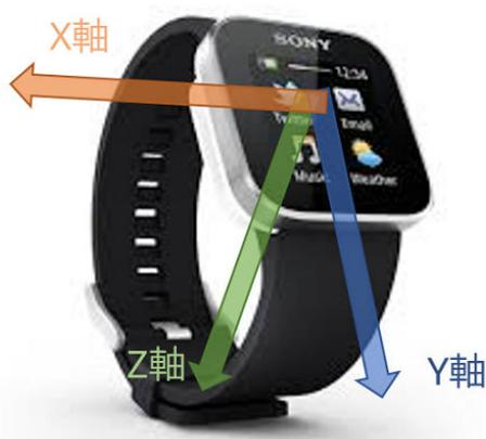
図 4.8: Watch の加速度センサの軸方向
