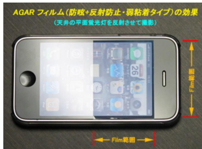
図 4.4: 反射防止フィルムを用いた場合と用いない場合の比較
