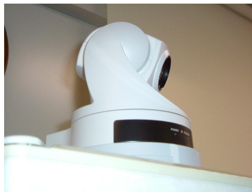
図 3.1: P.T.Z 機能をもつネットワークカメラ
