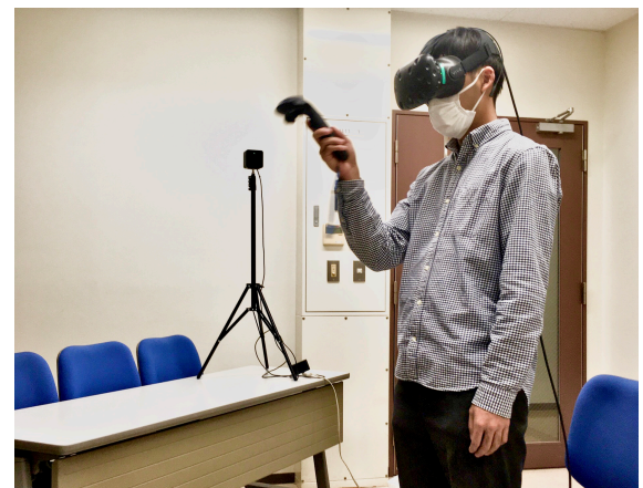
図 3 実験を行う参加者. HMD を頭部に装着し, 利き手 (右手) に把持したコントローラにて物体選択を行う.
