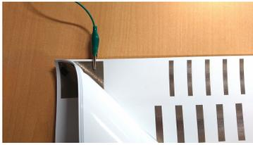
図6 識別子とワニ口クリップの接続.
