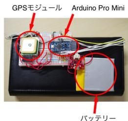
図3 作成したプロトタイプの外観
