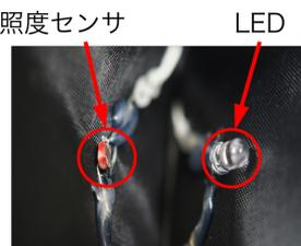
図5 ポケット内部の拡大図
