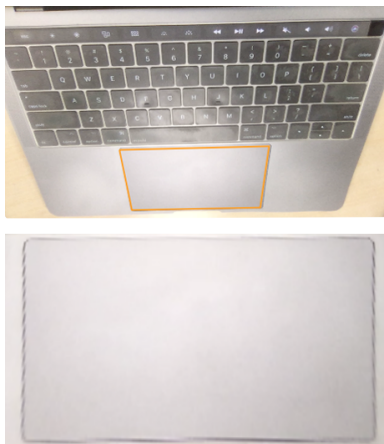
図 4 鏡を取り付けたインカメラから取得されるキーボードおよびタッチパッド周辺の映像(上)。射影変換により表示されたタッチパッド領域の映像(下)。
