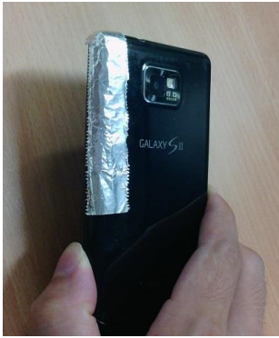
図 5 アルミニウム箔を貼った端末
