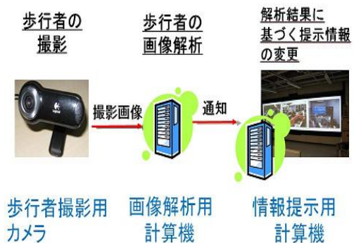
図 4 システム構成図
