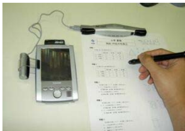
図5 SnailClientCE：生徒が書いた筆跡情報を、デバイスにより取得し教師側の計算機にリアルタイムで送るシステム
