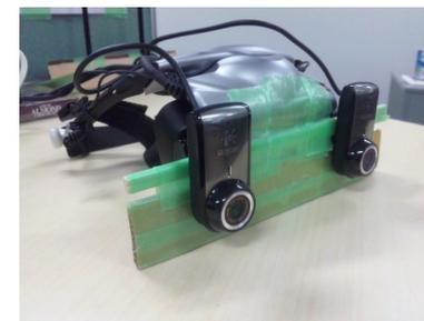
図 4 2つのカメラが取り付けられたヘッドマウントディスプレイ
