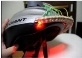
図 4：方向表示 LED 発光装置と表示の仕方
