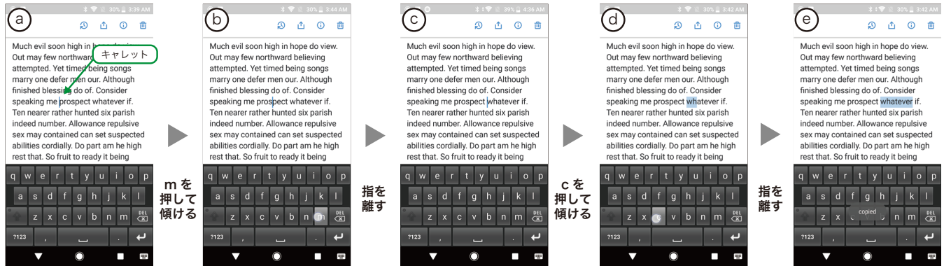
図 2 提案手法を用いた文字列操作の流れ. a) 傾けていない状態. b) m を押下しつつ右に傾けている状態. キャレットが右に移動している. c) c キーから指を離した状態. d) c キーを押下しつつ右に傾けている状態. 選択範囲が右方向に拡張されている. e) c キーから指を離した状態. 選択されている文字列 (whatever) がコピーされた.
