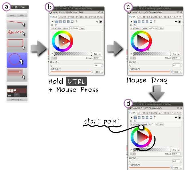
図 5 円対応付け . a) 対応付け手法の選択 , b) CTRL キーを押しながら円の中心を pressesする , c) 円を描く , d) 円の最上点が開始点として物理スライダの上端に割り当たる右回りに動作する .
