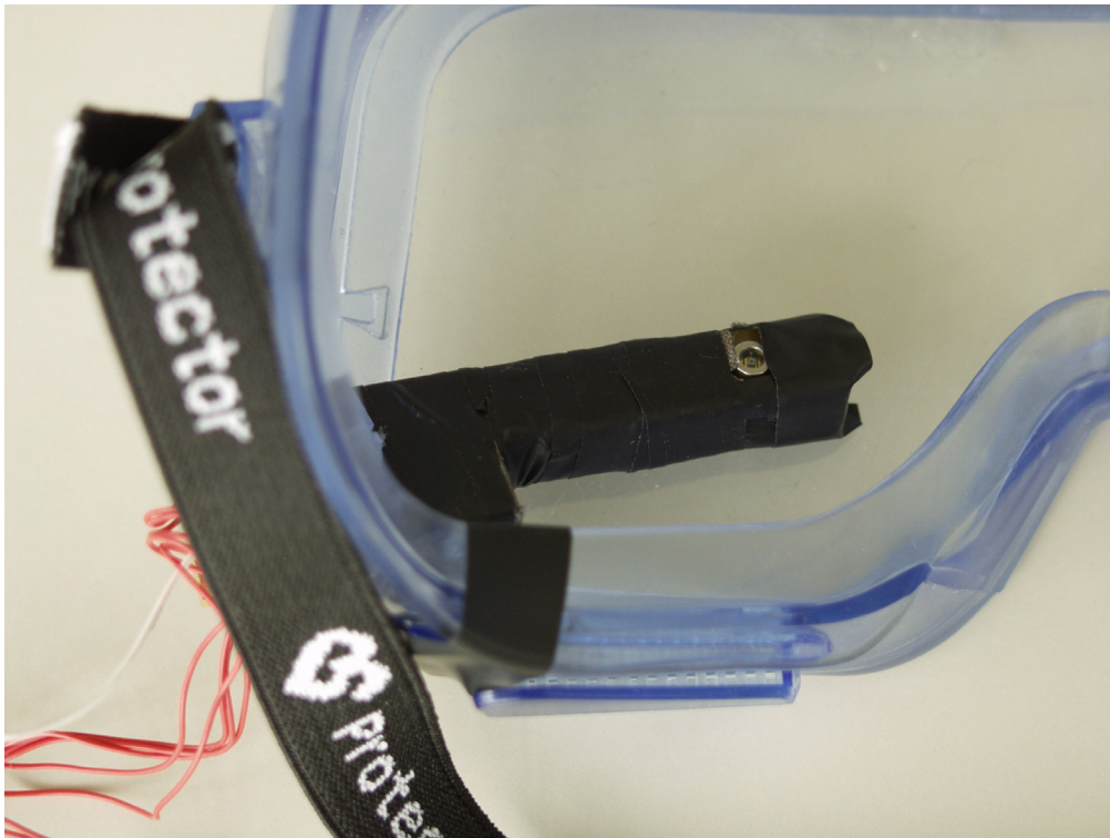
図 4.23: RealEyeCommunicator の受光器とイメージセンサの位置関係
