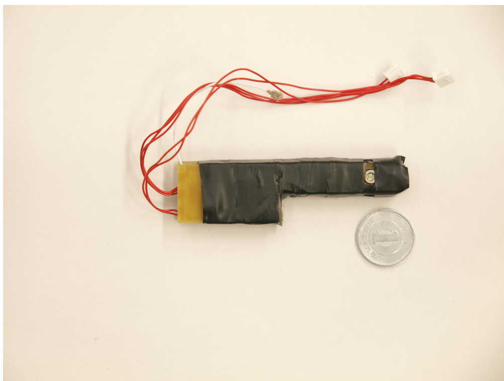
図 4.24: RealEyeCommunicator の受光器および増幅回路部
