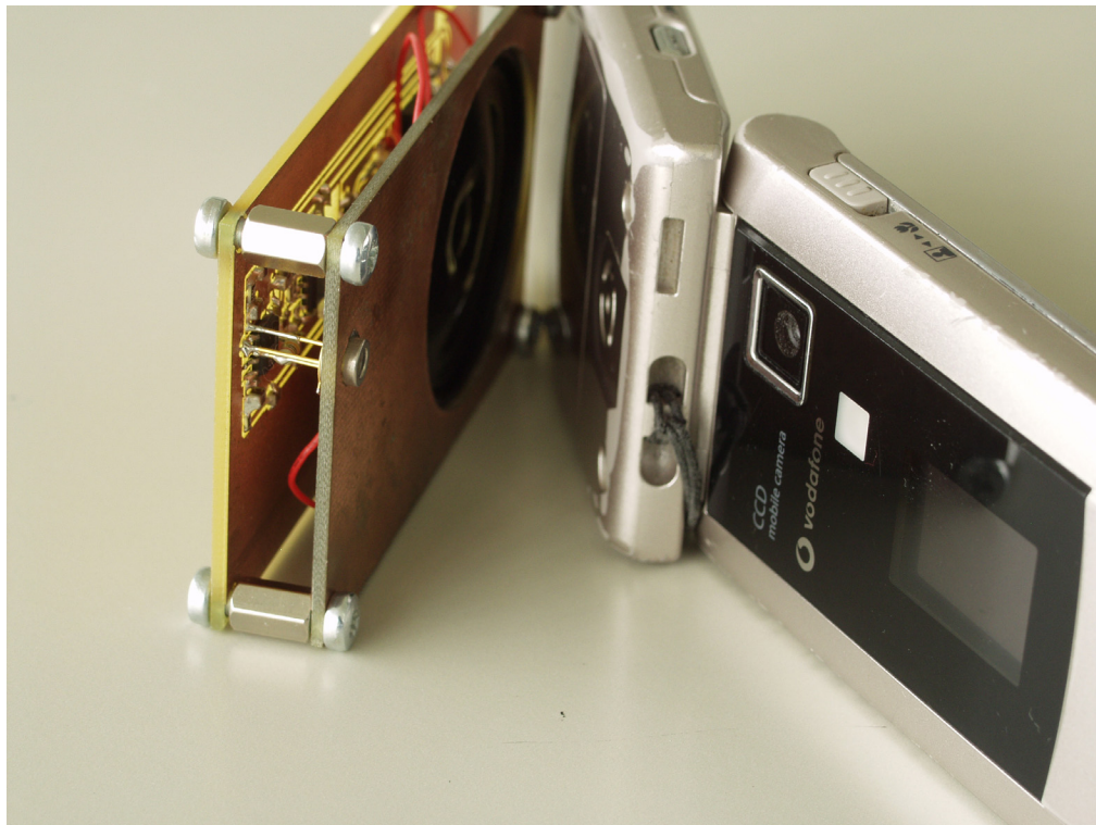
図 5.1: PointSpeech システムの受光器とイメージセンサの位置関係
