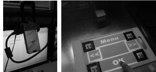
図 3: (左)プロジェクタと USB カメラ、 (右)測域センサによるタッチ認識
