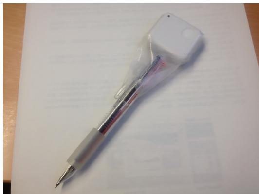
図2: 加速度センサを取り付けた筆記具
