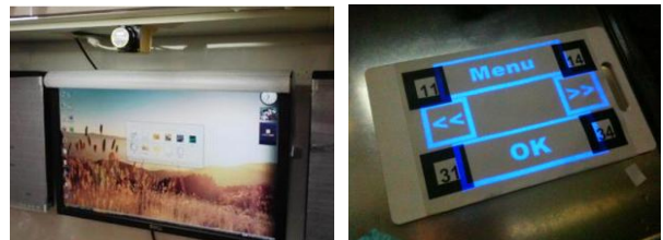
図1 左：側域センサとディスプレイ 右：まな板を用いたタッチディスプレイ
