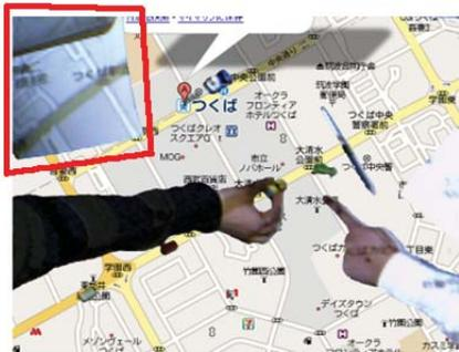
図 7 不要な映り込みが発生している例 (一方の作業員の持つノートに地図が投影されてしまっている)
