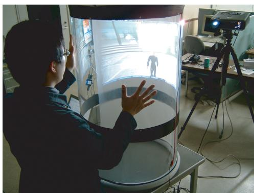
図 3: 円筒型マルチタッチインタフェース
