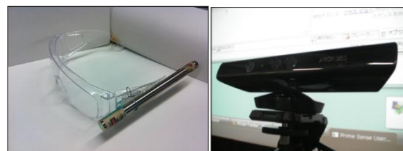
図 6 プロトタイプで使った レーザーポインタ（左）と距離カメラ（右） Fig.6 Laser pointer (left) and depth-based camera (right) used in the prototype
