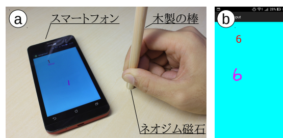
図 1: システム図。a: 操作イメージ, b: 操作画面 (b 上: 認識された数字, b 下: 推定位置)
