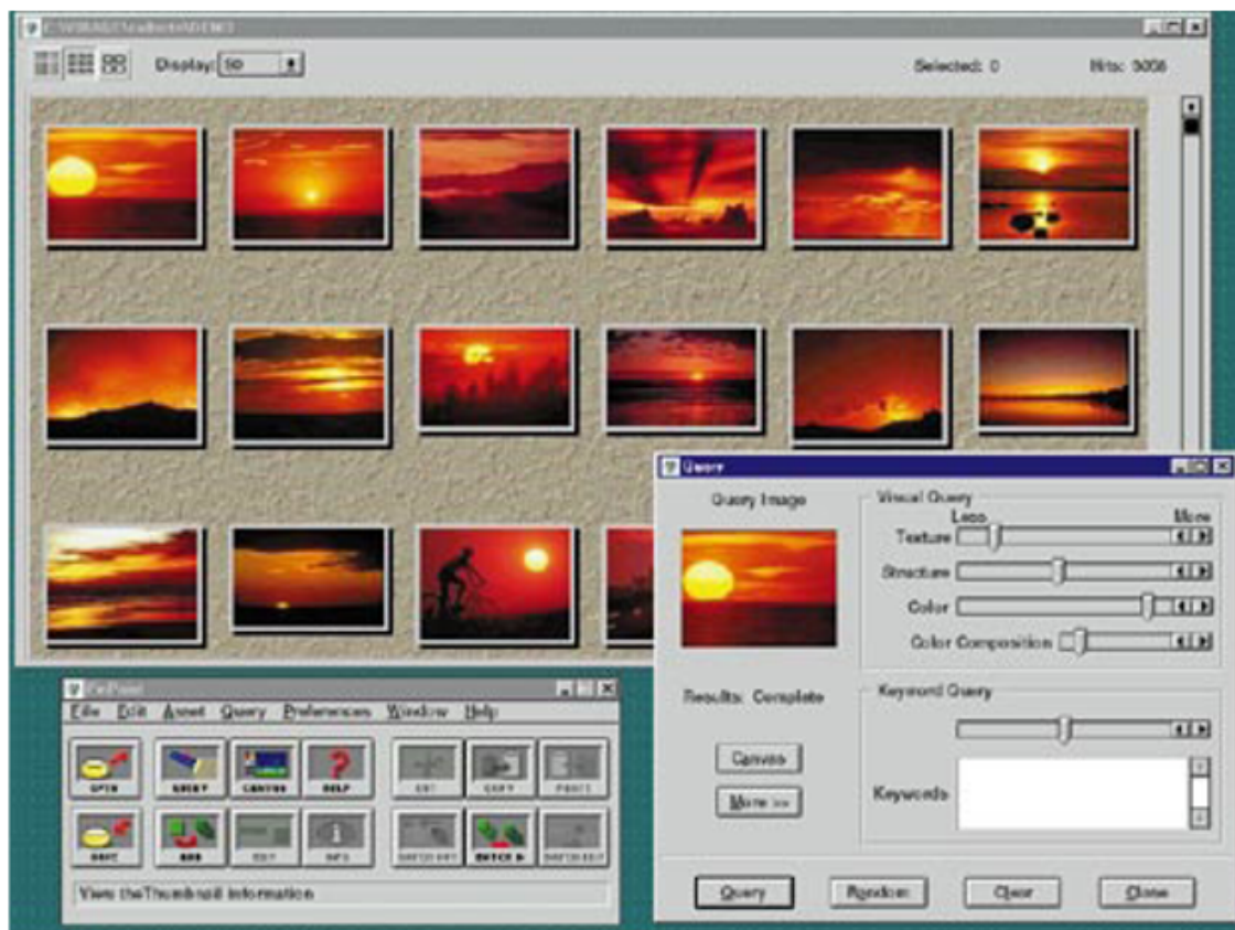
図 2.1: 画像の類似度によって画像の検索を行うシステム
