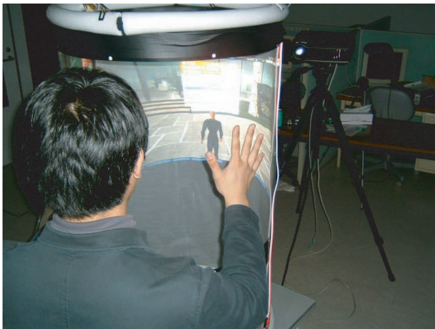
図 4.15: 円筒型マルチタッチインタフェースによるセカンドライフの操作
