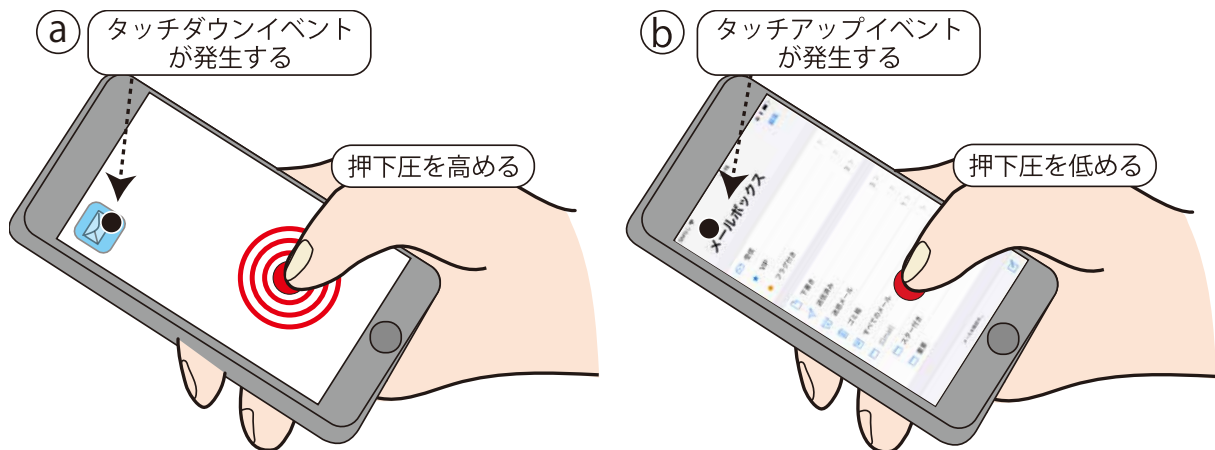
図 1.1: 押下圧を用いたイベントトリガ. a: 押下圧を高めることによってタッチダウンイベントを発生させアプリケーションを選択, b: 押下圧を低めることによってタッチアップイベントを発生させ選択したアプリケーションを起動.
