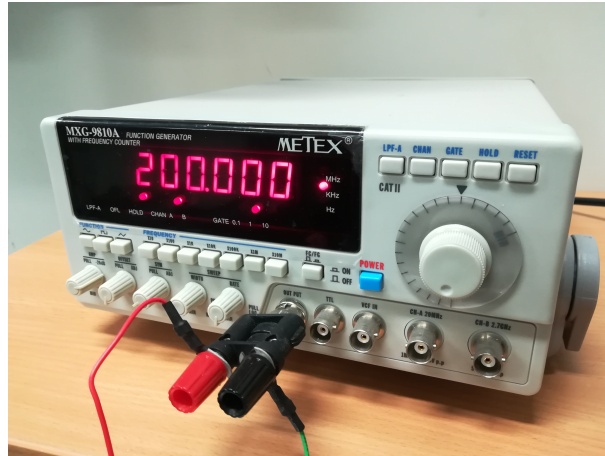
図 4.3 プロトタイプに使用した波形発生器
