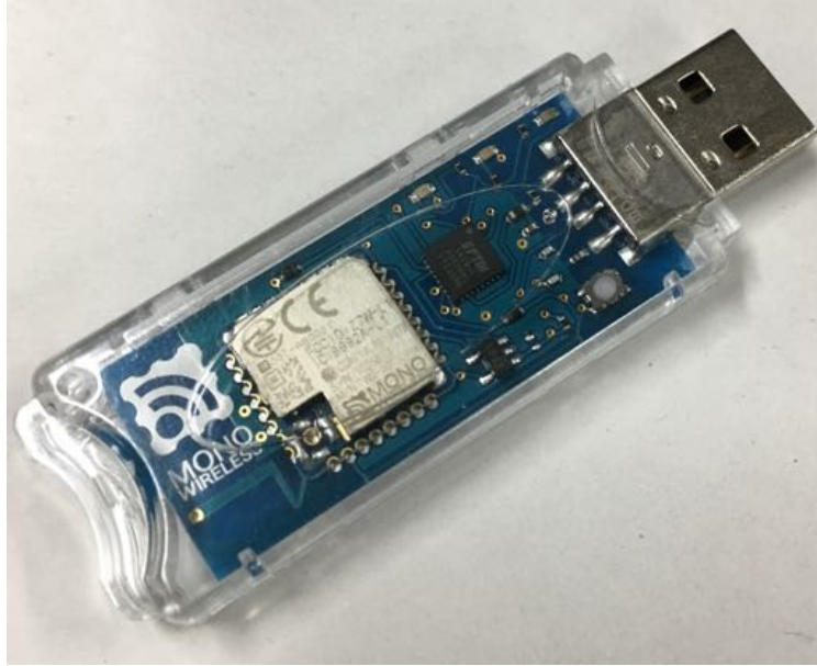
図 4.3: 無線中継器, MONOSTICK 3 (MonoWireless Inc.). USB 端子が搭載されており, スマートフォン, タブレット等, 様々な機器に接続することができる.
