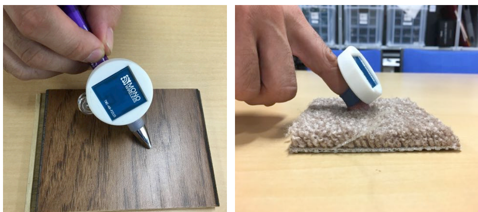
図 4.5: 触覚情報収集の様子。TWE-Lite-2525A 2 を 3D プリントで作成したケースに入れ、指やペンに装着する。実際の収集の際には TWE-Lite-2525A 2 を覆い隠すようにケースに蓋をし、触察時にデバイスがケースの外に出ないようにする。
