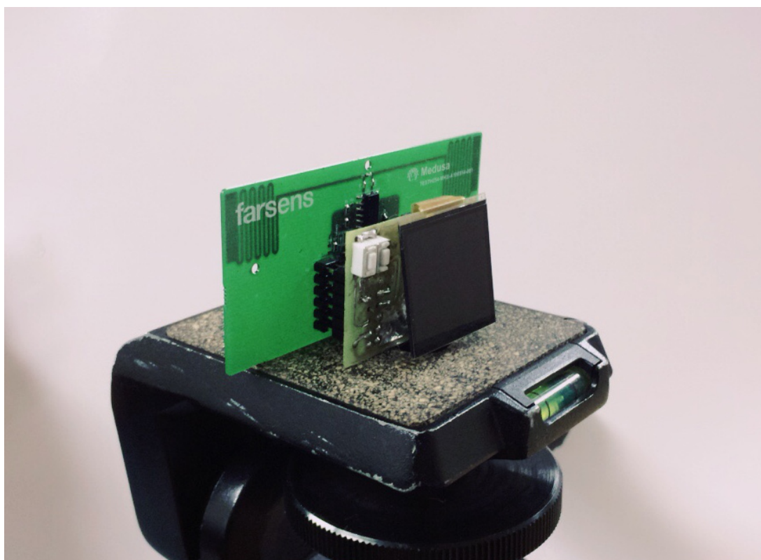
図 5.1: 三脚にのせた TAGParts . TAGParts を図のように載せ , 地面と垂直な軸に回転させる .
