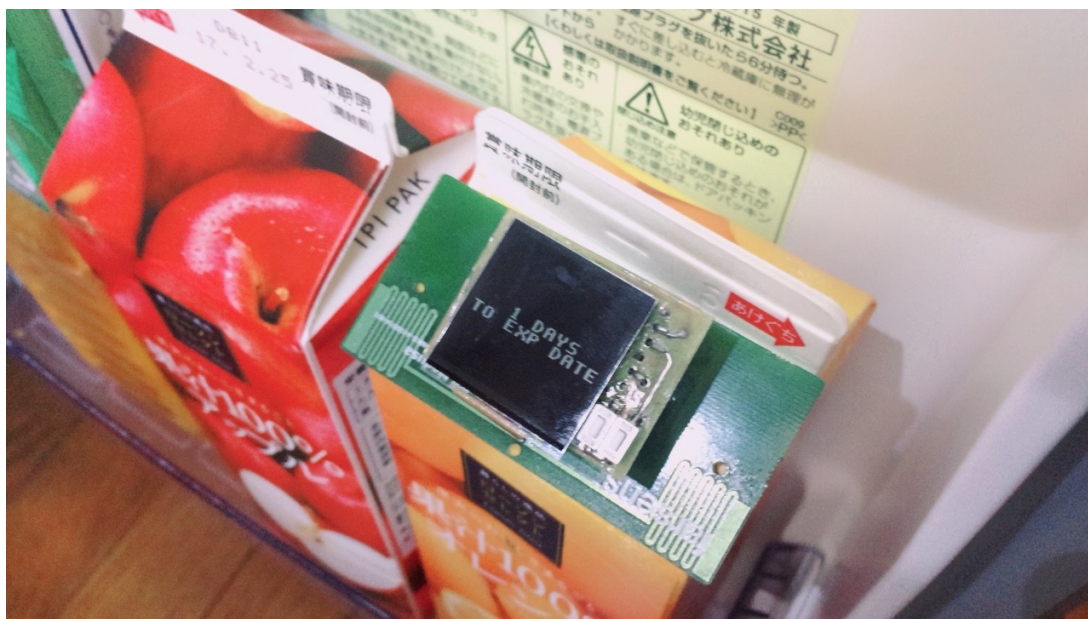
図 6.4: ジュースの賞味期限の通知を行っている様子．紙パックのジュースに TAGParts-Disp を貼り付けている．ディスプレイは賞味期限が残り 1 日であることを示している．
