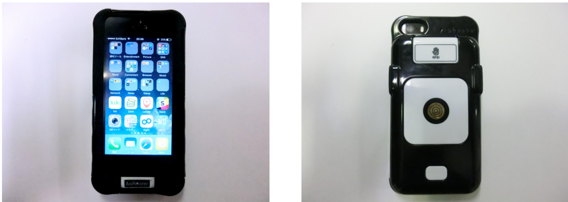
図 4.1: ASR-030D を iPhone 5s に取り付けた様子．左が前面，右が裏面である．RFID リーダは iPhone 5s の裏に取り付けられ電波を発する．
