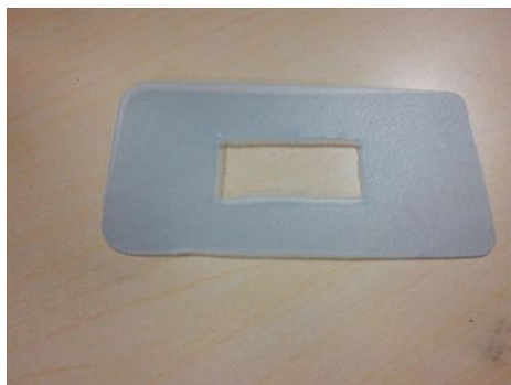
図 3.6: タッチパネルに唇を反応させなくさせるためのプラスチックシート
