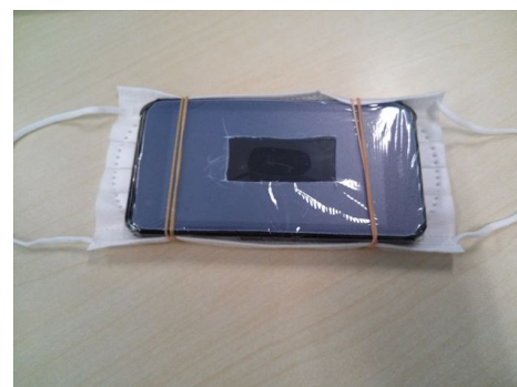
図 3.6: タッチパネルに唇を反応させなくさせるためのプラスチックシート
