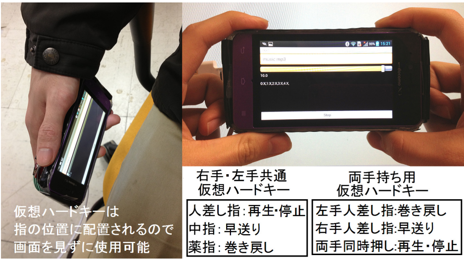
図 3.7: 音楽再生アプリケーションの使用場面
