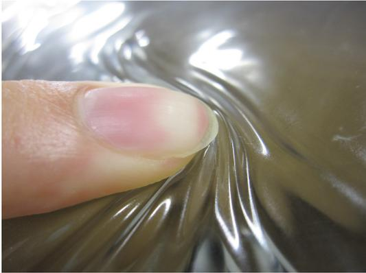
図 3.4: スラストをしたときのタッチパネル面の様子
