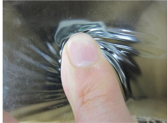
図 3.5: ツイストをしたときのタッチパネル面の様子
