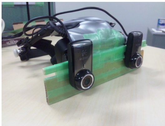
図 4.1: 2つのカメラが取り付けられたヘッドマウントディスプレイ
