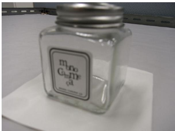
図 4.1: マーカを取り付けたカプセル
